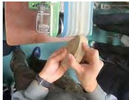
図 14 ベルトサンダーでの成形
